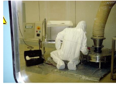
Der überschallschnelle Luftstrahl wird in das Zentrum der Mühle geleitet. Das Produkt bleibt außer der Mikronisierung völlig naturbelassen.
