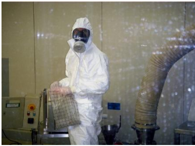
Der Spezialist nimmt eine Probe des Granitpulver-Gemisches um die gewünschte Mikronisierung in den Hochdruckmühlen zu bestimmen.
