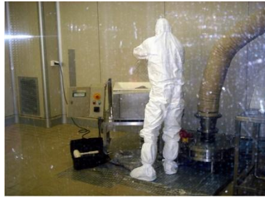
Die Gesteinsprobe wird in die Mühle gegeben, wo die Partikel mit hoher kinetischer Energie gegenseitig fragmentiert werden.
